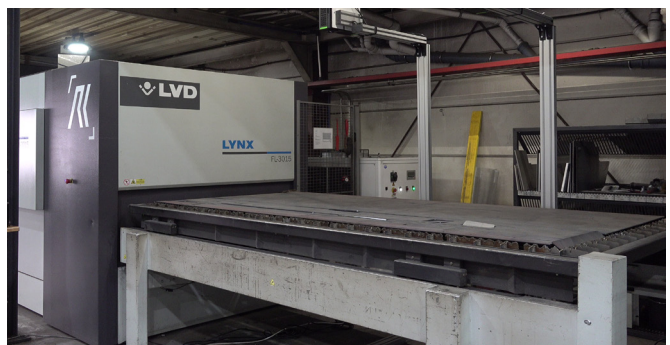
Kommissionier-Assistent an einer Laserschneideanlage für eine effizientere Blechbearbeitung
