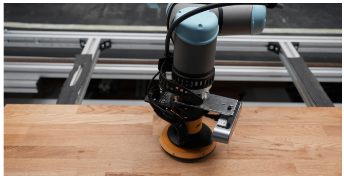
Schleifen von Holzpanelen
