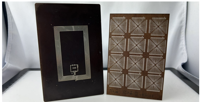
Inkjet-gedruckte Elektronikbauteile aus nachwachsenden Rohstoffen
