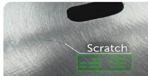
Kennzeichnung der Defektklassifikation und Fehlerparameter
