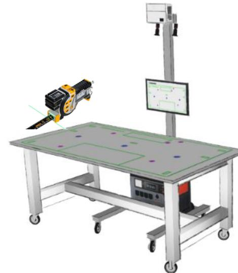
Beispiel Küchenplattenfertigung: flexibles, mobiles System für Werkbänke mit PC, Kamera, Projektor, Monitor, digitaler Rollmeter
