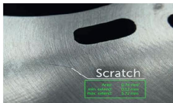
Kennzeichnung der Defektklassifikation und Fehlerparameter
