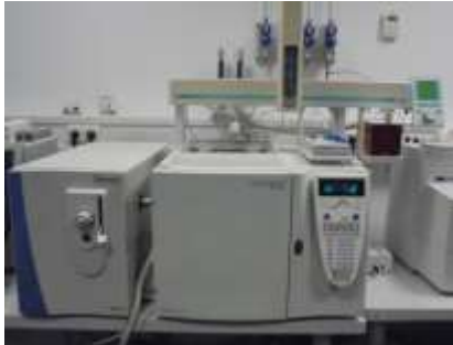
Thermo Finnigan Trace GC mit FID und Massenspektrometer DSQ II
