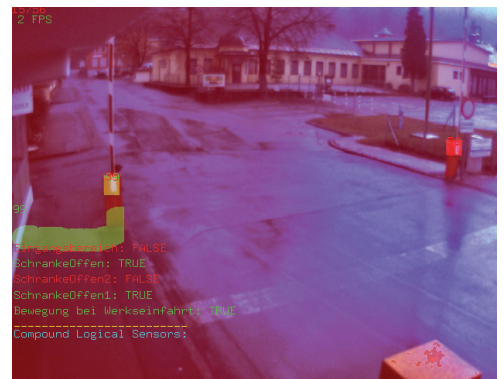
Überwachung einer Werkseinfahrt (Schranke offen/geschlossen)
